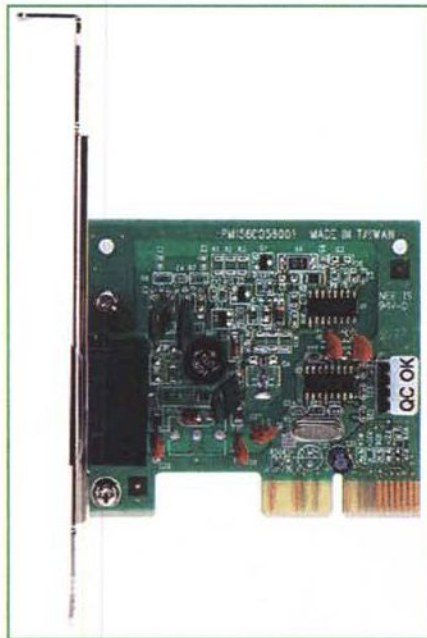
Modem AMR di produzione Asus: come si può notare confrontando questa immagine con le seguenti illustranti i modem in prova, un "softmodem" è costituito dal minimo indispensabile di componenti atti al collegamento fisico alla linea PSTN.
